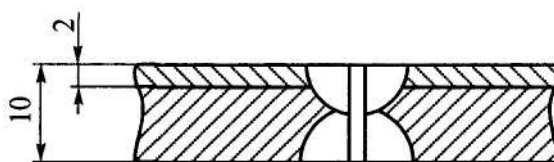
Рис. 18. Образец для испытания на ударный изгиб сварных соединений из двухслойных сталей
